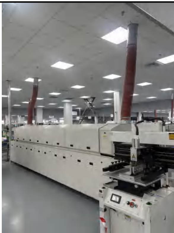
回流焊密闭集气管道
