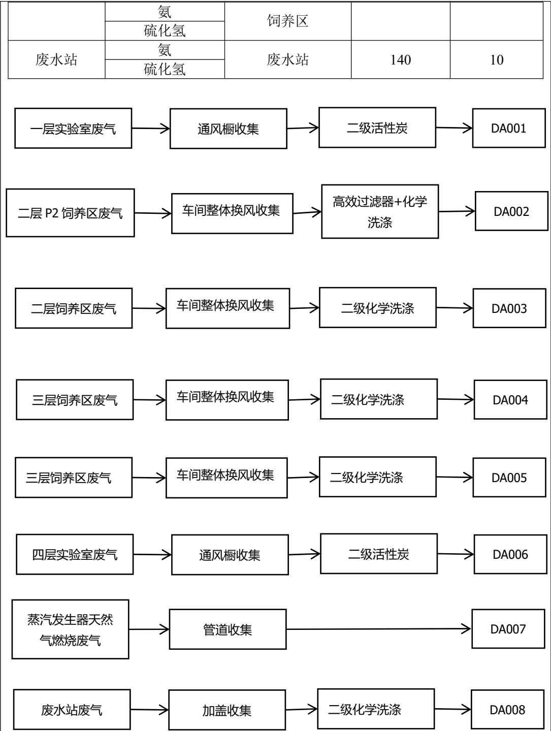
图 3-2 废气收集处理流程图
