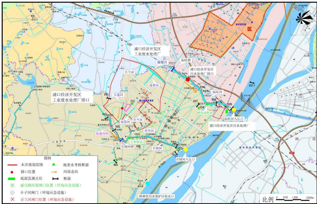
图 4-2-7 水系、污水处理厂排口及河道闸坝位置标识图
